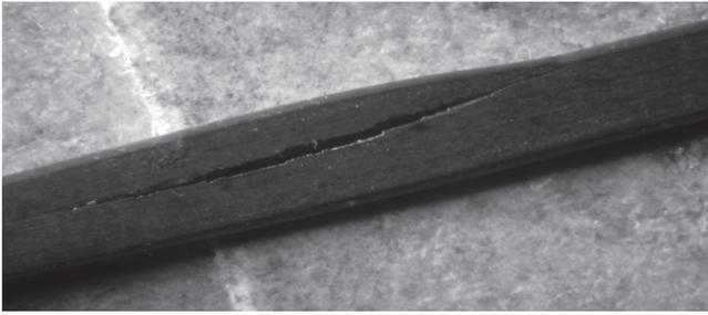
Рис. 3. Вид продольной трещины на плющенной проволоке
