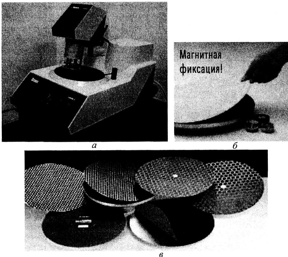
Рис. 7. Шлифовально-полировальный станок Laborol с приспособлением LaboForce для полуавтоматической подготовки от 1 до 3 металлографических образцов (а) с магнитной фиксацией шлифовально-полировальных дисков (б); алмазные диски MD-Piano, MD-Largo и MD-Allegro для шлифования материалов HV 40–150, 150–2000, стальные композиционные диски со спецпокрытием сотовой формы для шлифования, полировальное сукно MD Polishing Cloths (в)
