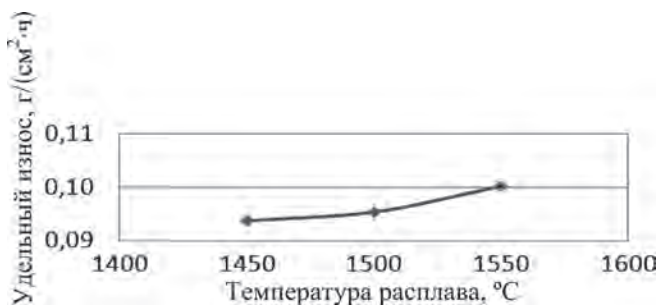
Рис. 3. Влияние температуры расплава на износостойкость
