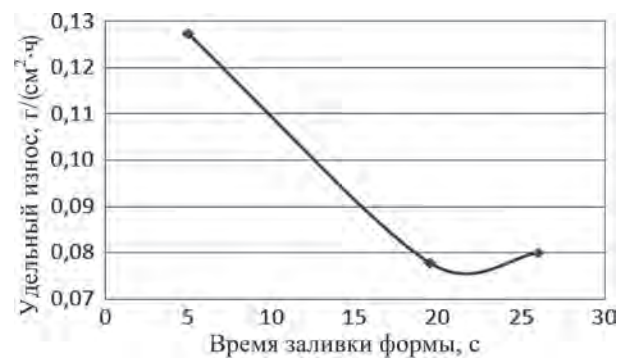
Рис. 4. Влияние времени заполнения формы расплавом на износостойкость
