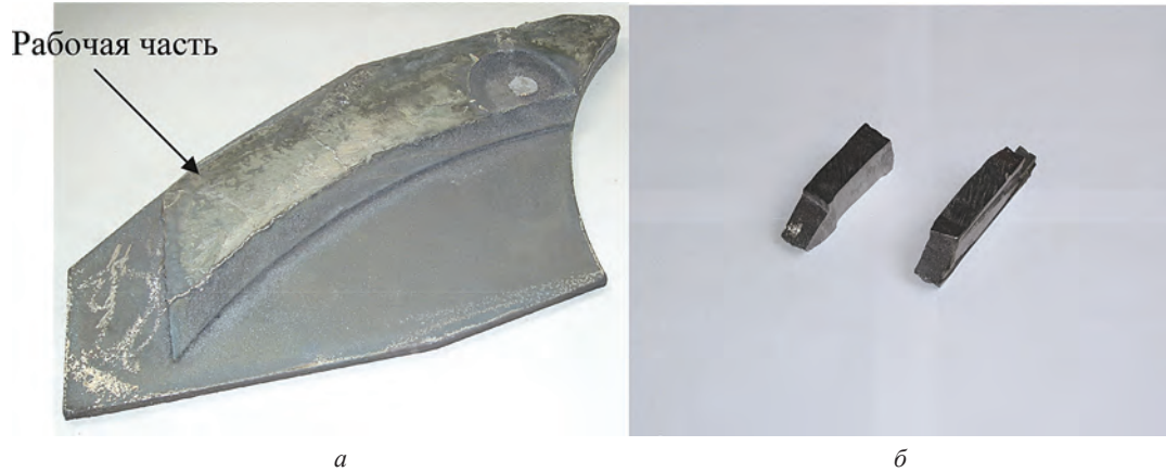
Рис. 2. «Подкладной лист» УЗ-1,25 (а) и образцы, вырезанные из него (б)
