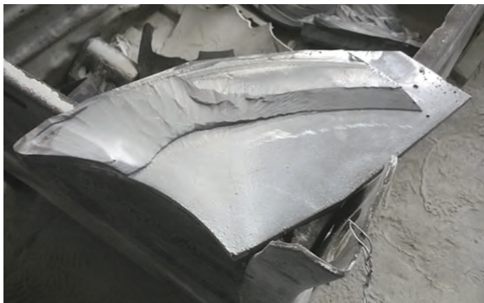
Рис. 5. Характерный износ детали «подкладной лист»
