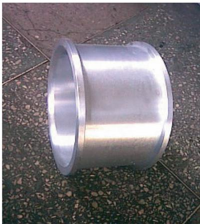
Рис. 2. Тяжелонагруженный вкладыш подшипника скольжения
