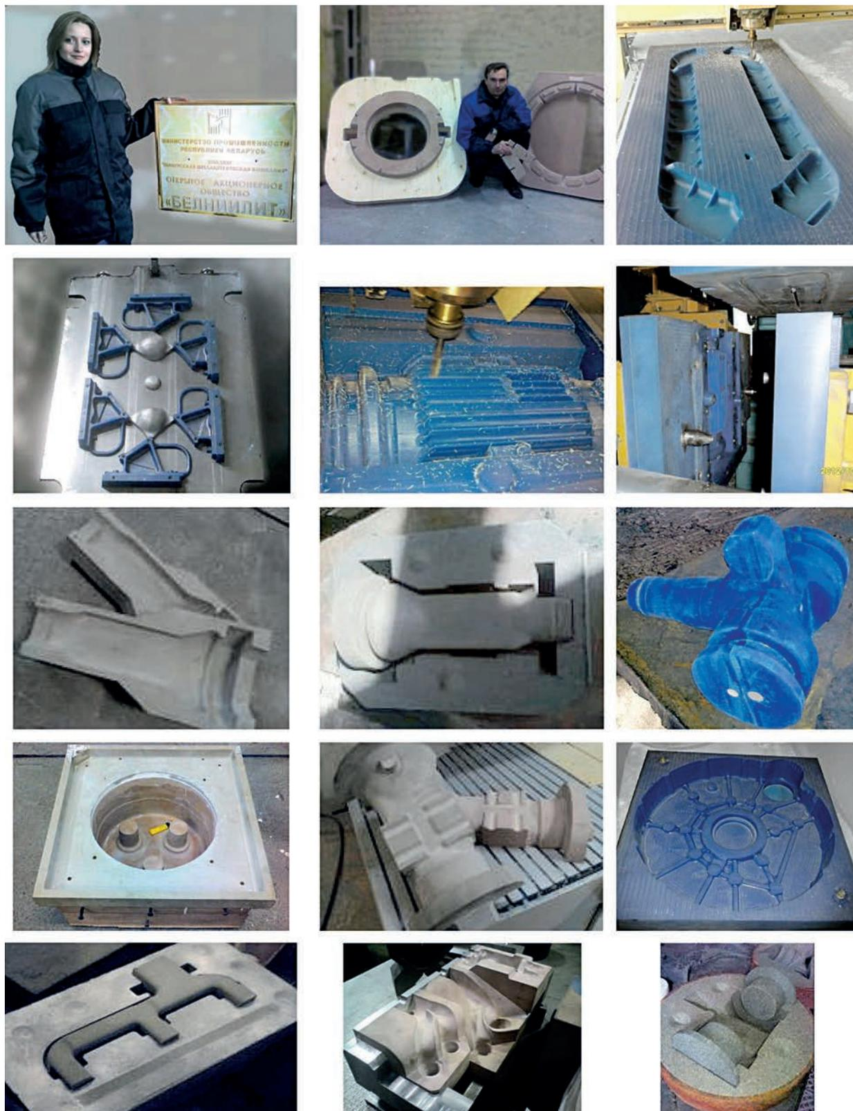
Рис. 4. Примеры литейной оснастки, рабочие моменты изготовления оснастки и сборки форм
