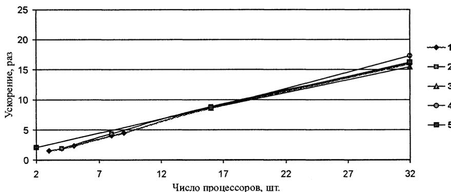
Рис. 9. Зависимость ускорения моделирования от числа процессоров (2–32шт.) для отливок: 1 – Вариант 1 («Змея»); 2 – Вариант 2 («Угольник»); 3 – Вариант 3 («Угольник»); 4 – Вариант 4 («Радиатор»); 5 – общая линия тренда
