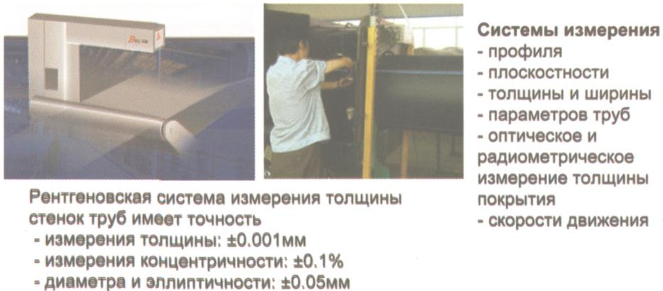
Рис. 22. Автоматический контроль качества параметров готовой продукции
