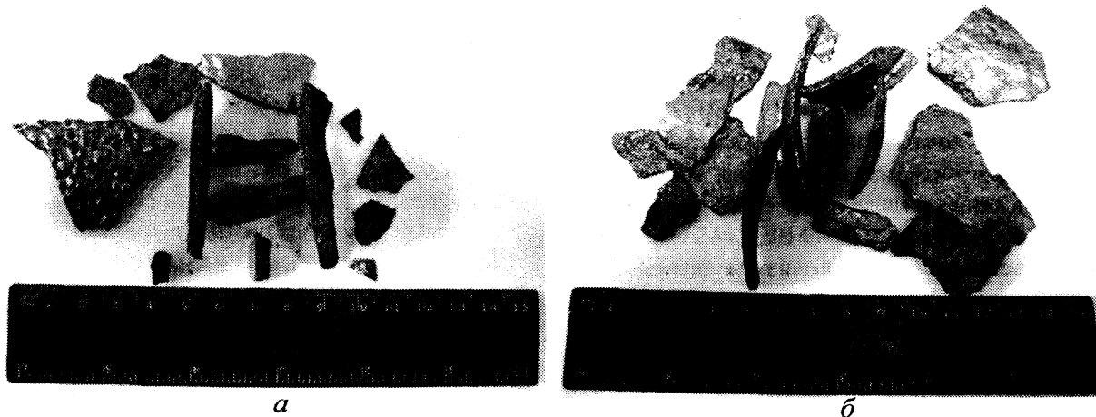
Рис. 2 Средние по толщине куски окалины: а – первая исследованная печь; б – вторая исследованная печь
