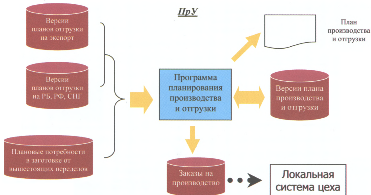
Рис. 7. Поток данных для программы планирования производства
