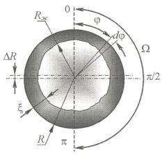
Рис. 2. Схема расчета горизонтальной отливки
