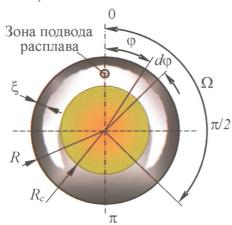
Рис. 1. Схема расчета вертикальной отливки
