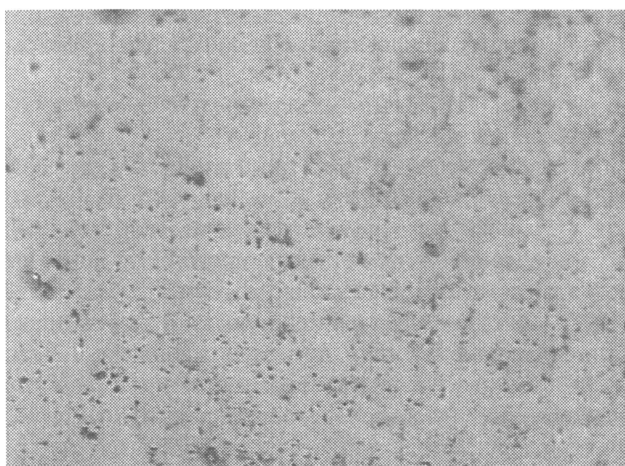
Рис. 3. Слой смазки на основе кремнийорганического соединения. х125
