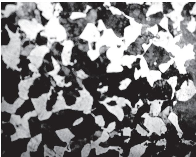
Рис. 5. Феррито-перлитная структура необработанной модифицированной литой стали. x200
