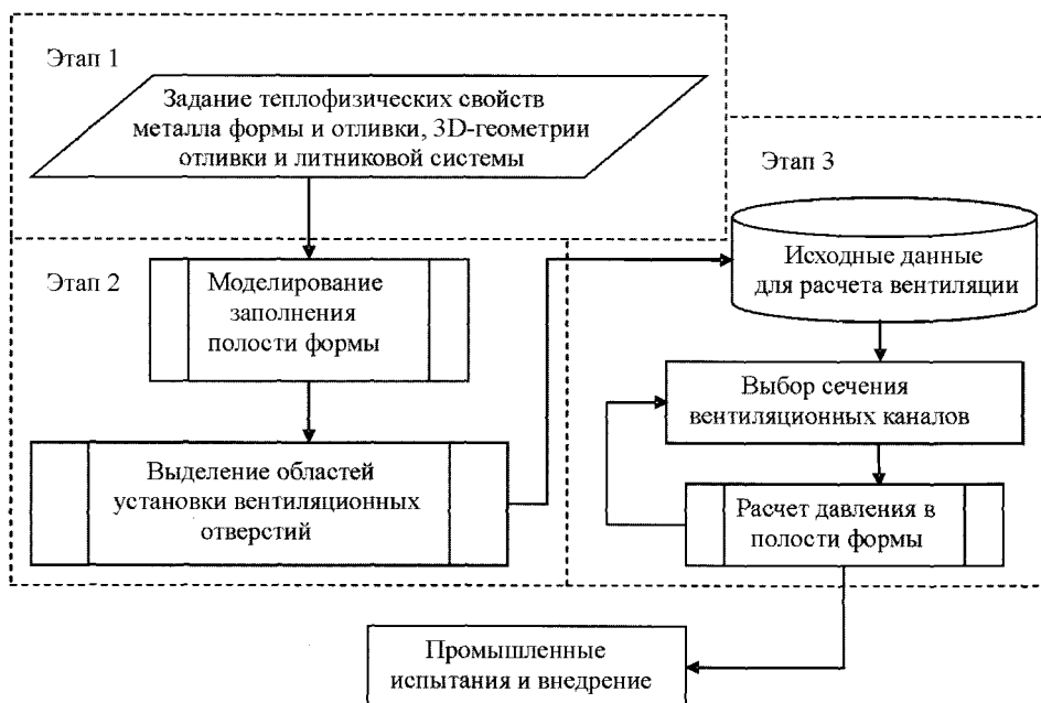
Рис. 1. Общая схема расчета сечения вентиляционных отверстий и определения их положения
