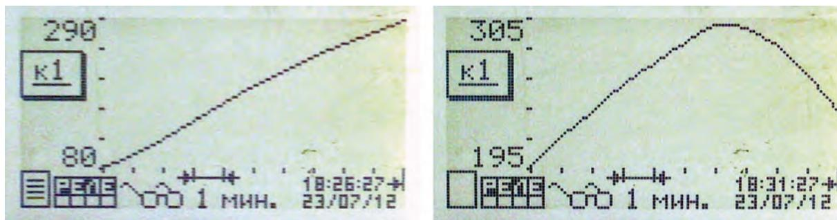
Рис. 14. Мониторинг нагрева шихты на установке подогрева в завалочных бадьях на ОАО «Завод стальной дроби», г. Алчевск, Украина: k1 – температура отходящих газов на выходе из слоя шихты
