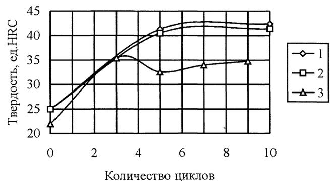
Рис. 4. Изменение твердости сплава ЭИ617 после закалки и ТЦВ: 1 – закалка от 1190°C и ТЦО 750–20°C; 2 – закалка от 1190°C и ТЦО 850–750°C; 3 – закалка от 1190°C, закалка от 1050°C и ТЦО 850–750°C
