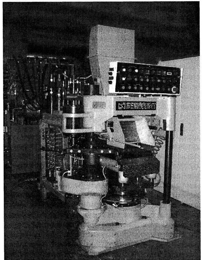
Рис. 6. Машина вертикально-стопочной формовки мод. 4812Э
