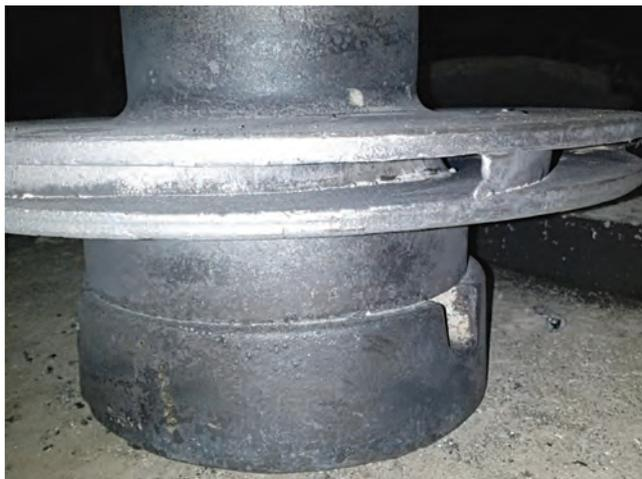
Рис. 2. Отливка «Рабочее колесо нефтяного насоса» после выбивки из формы
