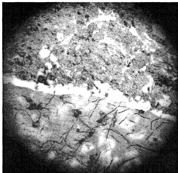
Рис. 3. Зона контакта «поршневой сплав—вставка под верхнее поршневое кольцо» с образованием переходного диффузионного слоя. \times 240 . Травлено 0,5% HF
