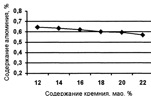
Рис. 2. Влияние концентрации кремния в сплаве на содержание алюминия в \beta_{Si} -фазе
