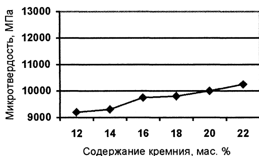
Рис. 1. Влияние концентрации кремния в сплаве на микротвердость включений \beta_{Si} -фазы
