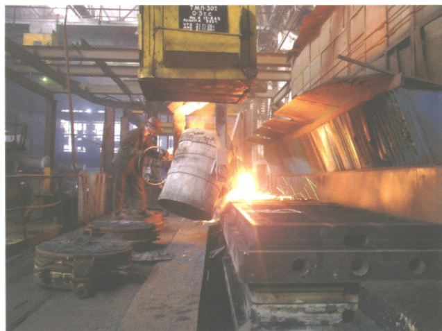
Заливка последней формы на старой линии
