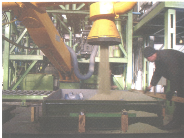
Набивка формы (No-Bake-процесс)
