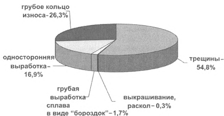
Рис. 1. Дефекты отработанных волок
