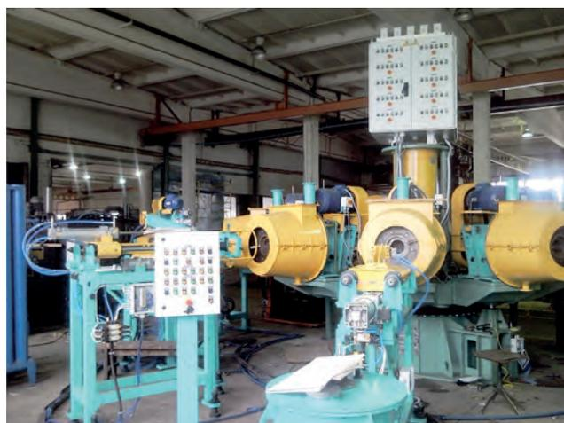
Рис. 2. Машина мод. 49101 с узлами автоматической покраски и дозированной заливки
