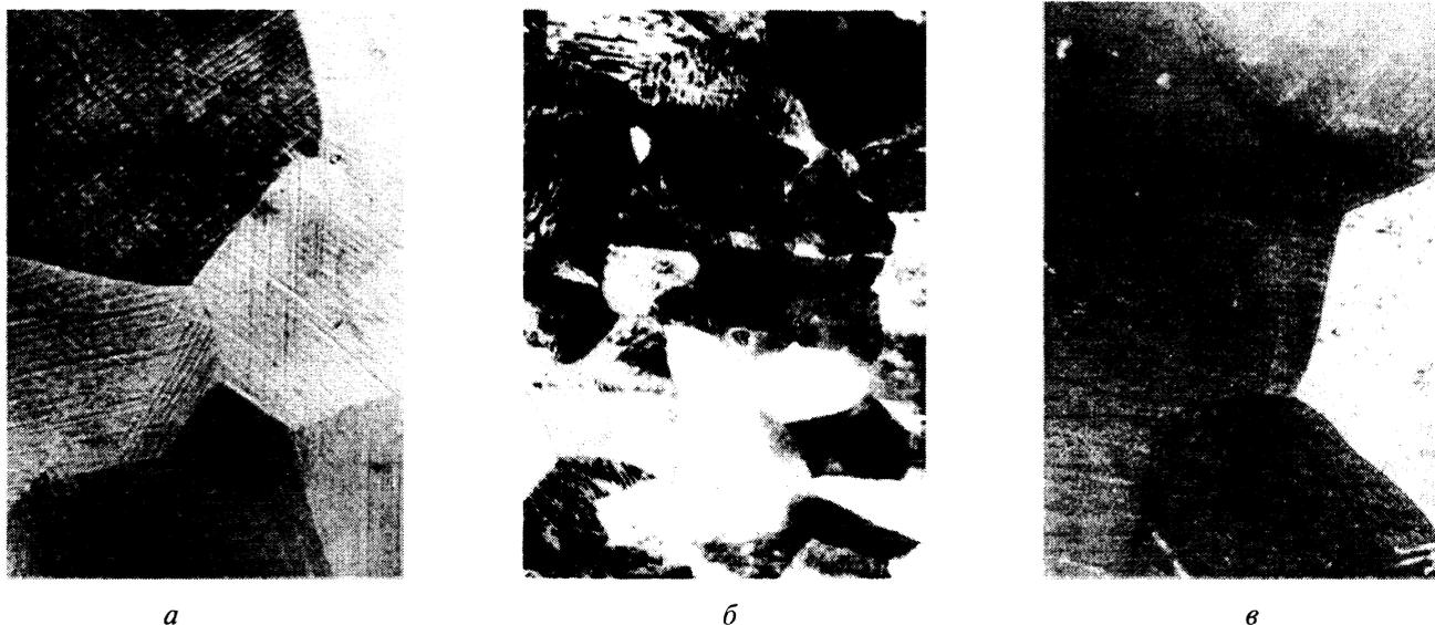
Рис. 3. Микроструктура стали 110Г13Л с различной концентрацией азота после закалки от 1100 °С: а – 0,01% N (азот не вводился); б – 0,065% N; в – 0,118% N. х320
