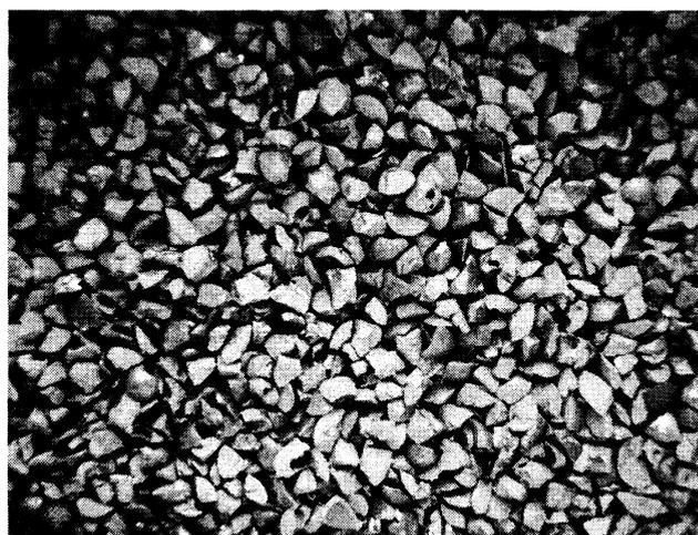
Рис. 1. Новая дробь марки GP18. Отчетливо видна остроугольная форма частиц
