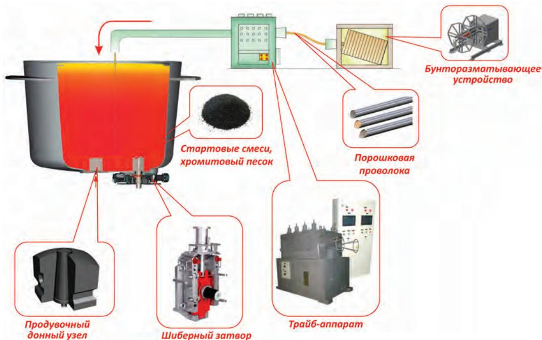
Рис. 1. Технологический комплекс внепечной обработки (доводки) стали и сплавов в ковше
