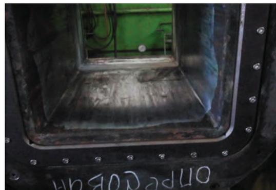
Рис. 6. Опытная гильза после прохождения 96 плавков
