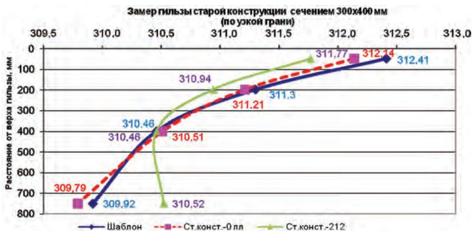
Рис. 8. Изменение геометрии гильзы по узкой грани в процессе использования
