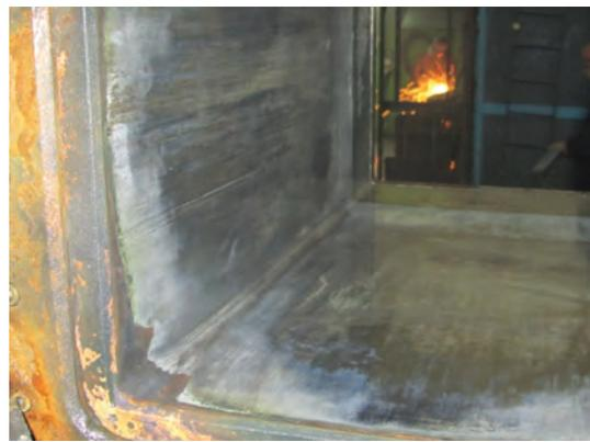
Рис. 12. Опытная гильза после прохождения 74 плавков
