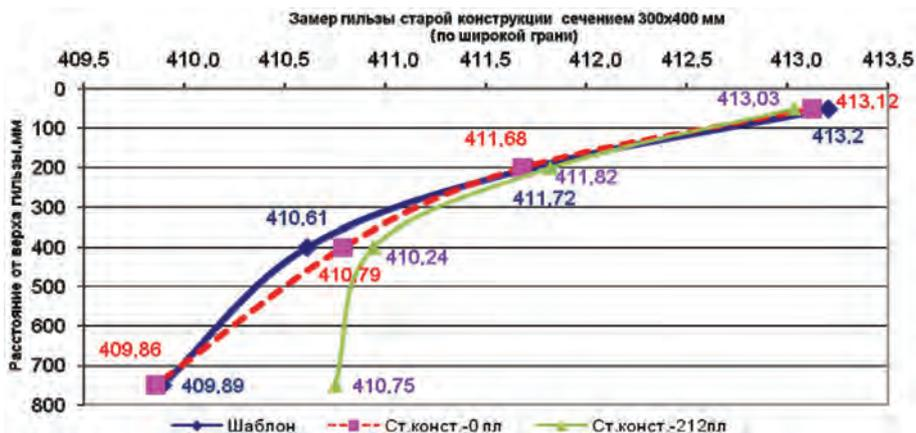
Рис. 7. Изменение геометрии гильзы по широкой грани в процессе использования
