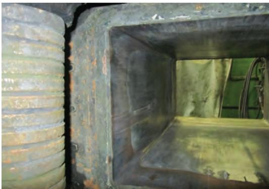
Рис. 5. Гильза после прохождения 89 плавков
