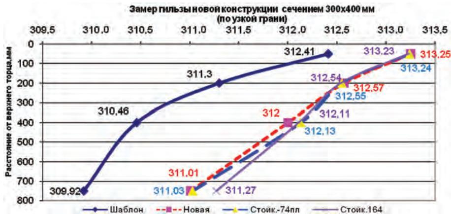
Рис. 10. Изменение геометрии гильзы по узкой грани в процессе использования
