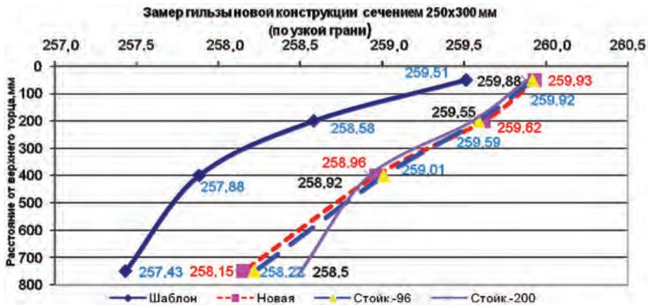
Рис. 4. Изменение геометрии гильзы по узкой грани в процессе использования
