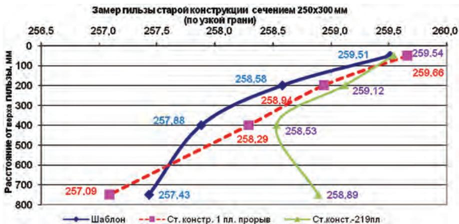
Рис. 2. Изменение геометрии гильзы по узкой грани в процессе использования
