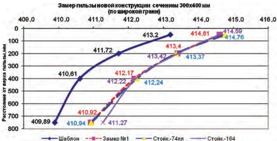
Рис. 9. Изменение геометрии гильзы по широкой грани в процессе использования
