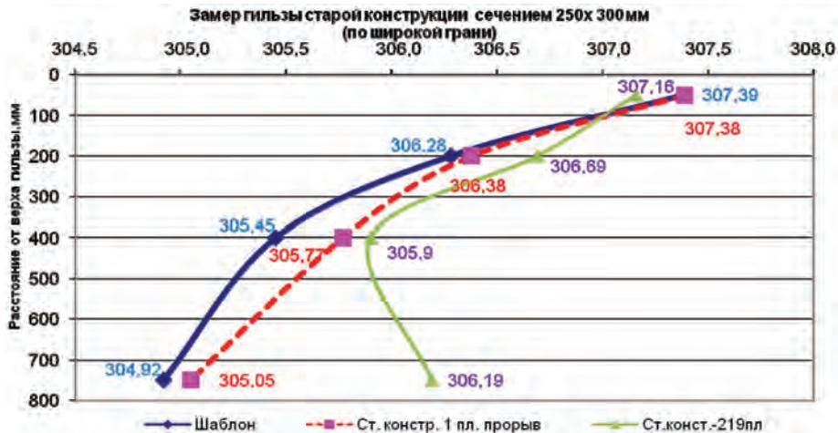
Рис. 1. Изменение геометрии гильзы по широкой грани в процессе использования
