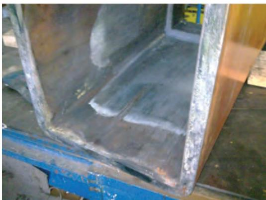
Рис. 11. Гильза после прохождения 88 плавков
