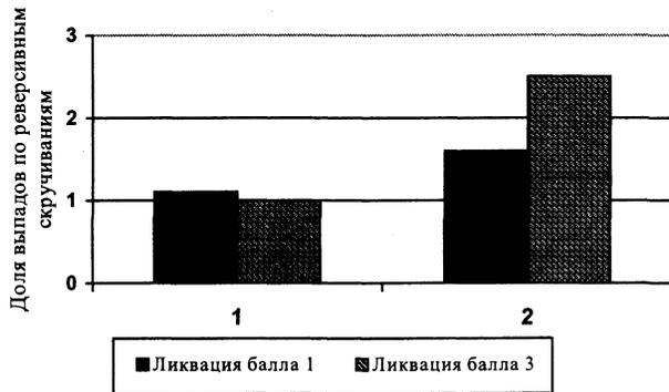
Рис. 2. Влияние подусадочной ликвации на пластичность проволоки РМЛ: 1 – испытания в состоянии поставки; 2 – испытания после старения
