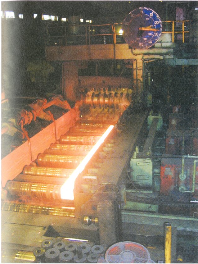
Рис. 3. Прокатный стан 850 для производства круглых заготовок диаметром 80–150 мм и квадратных заготовок сечением 125x125 мм
