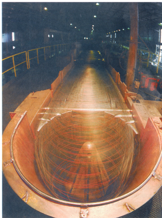
Рис. 6. Линия Стелмор, бунтоприемник стана 150
