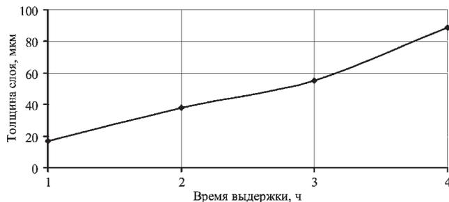
Рис. 4. Влияние продолжительности выдержки при термодиффузионном цинковании в системе гартцинк– $Al_2O_3$  на толщину цинкового слоя
