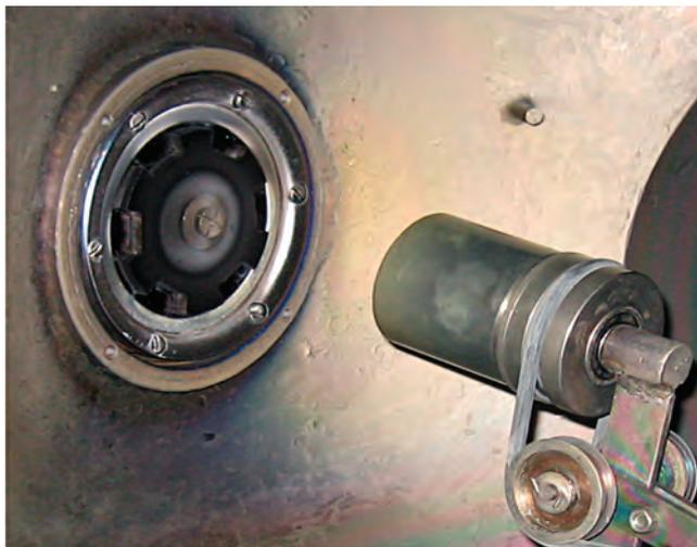
Рис. 1. Внешний вид распыляемого комбинированного катода и устройства для перемешивания порошка
