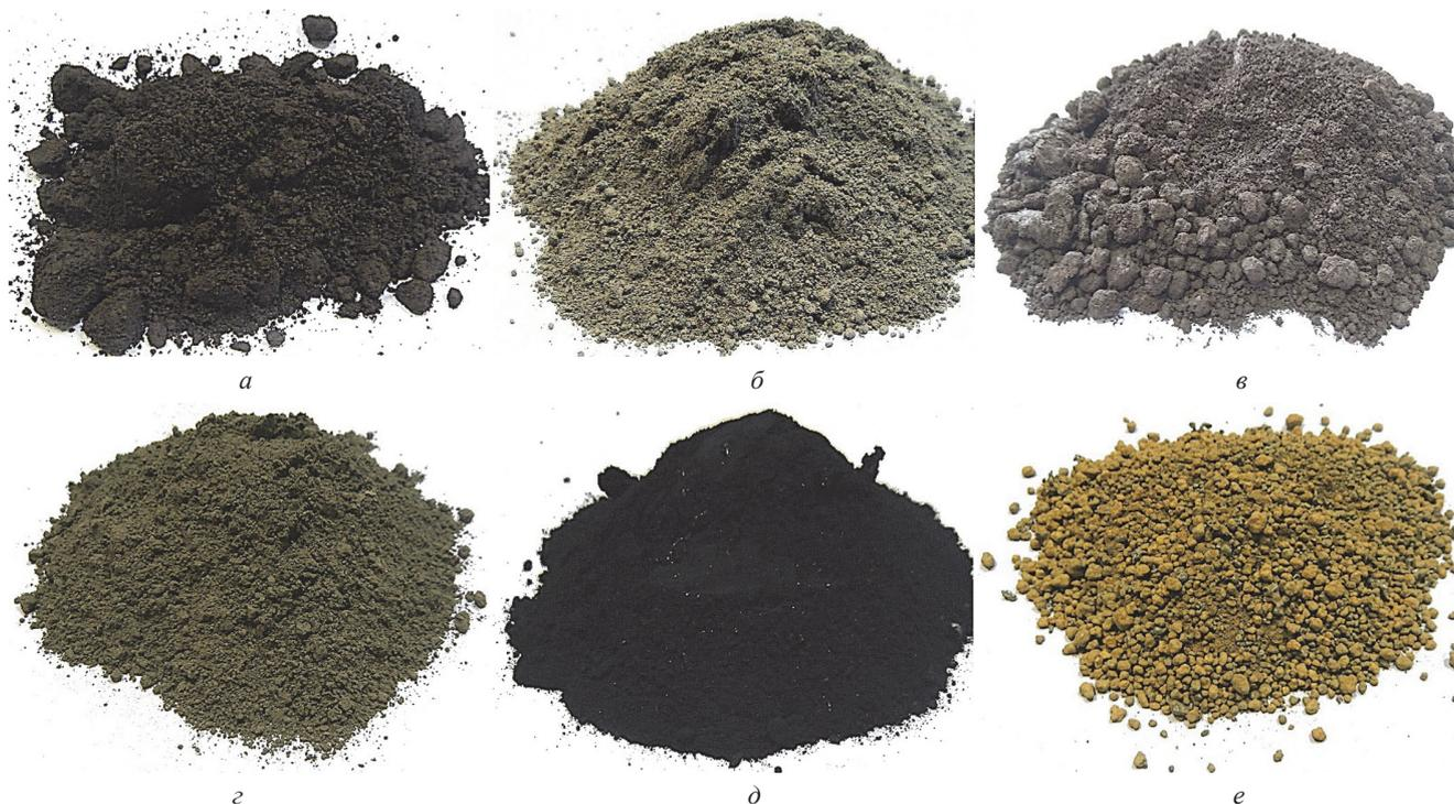
Рис. 1. Свинецсодержащие отходы: а – аккумуляторная паста; б – аспирационная пыль от ротационной печи; в – шлак ротационной печи; г – аспирационная пыль от рафинировочных котлов; д – черные съемы с рафинировочных котлов; е – желтые съемы с рафинировочных котлов
