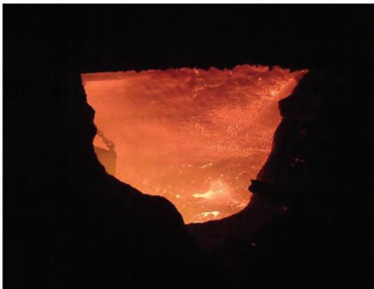
Рис. 4. Футеровка рабочего слоя стен закрыта гарнисажным слоем
