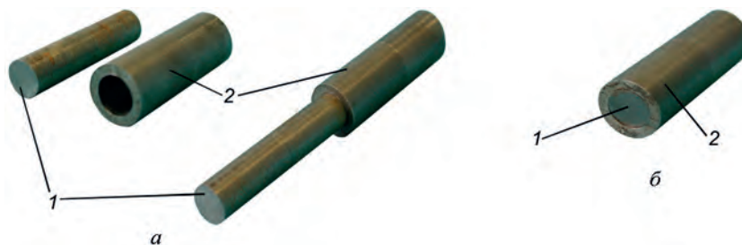
Рис. 1. Заготовки (а) и сборка перед прокаткой (б): 1 – центральный стержень из материала-основы стали 45; 2 – тонкостенная втулка из стали 12ХН3А
