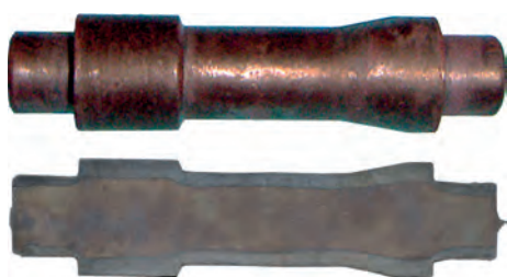
Рис. 2. Сплошной двухслойный вал с внешним слоем из стали 12ХН3А и внутренним слоем из стали 45
