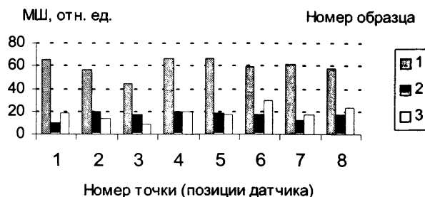
Рис. 1. Диаграммы показаний прибора РМША в точках цилиндрической поверхности отливок ниппеля для образцов с различной структурой поверхностного слоя
