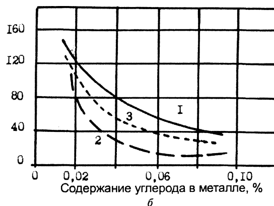
Рис. 3. Содержание азота в металле по опытным вариантам в лабораторных (а) и заводских (б) конвертерах: 1 – без потенциала; полярность потенциала по фурме: 2 – отрицательная; 3 – положительная
