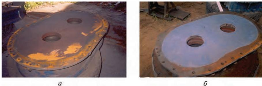
Рис. 2. Восстановленный узел компрессора (боковина) ОАО «ОЭМК»: а – до восстановления; б – после восстановления
