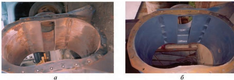
Рис. 1. Восстановленный узел компрессора (2-я ступень) ОАО «ОЭМК»: а – до восстановления; б – после восстановления
