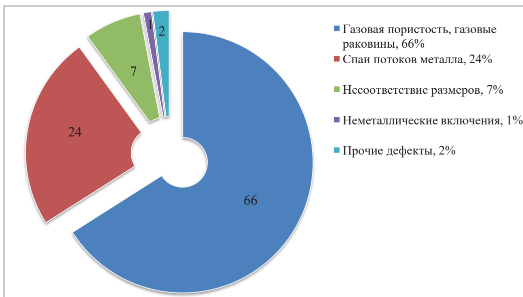
Рис. 1. Распределение различных видов брака отливок при ЛПД
