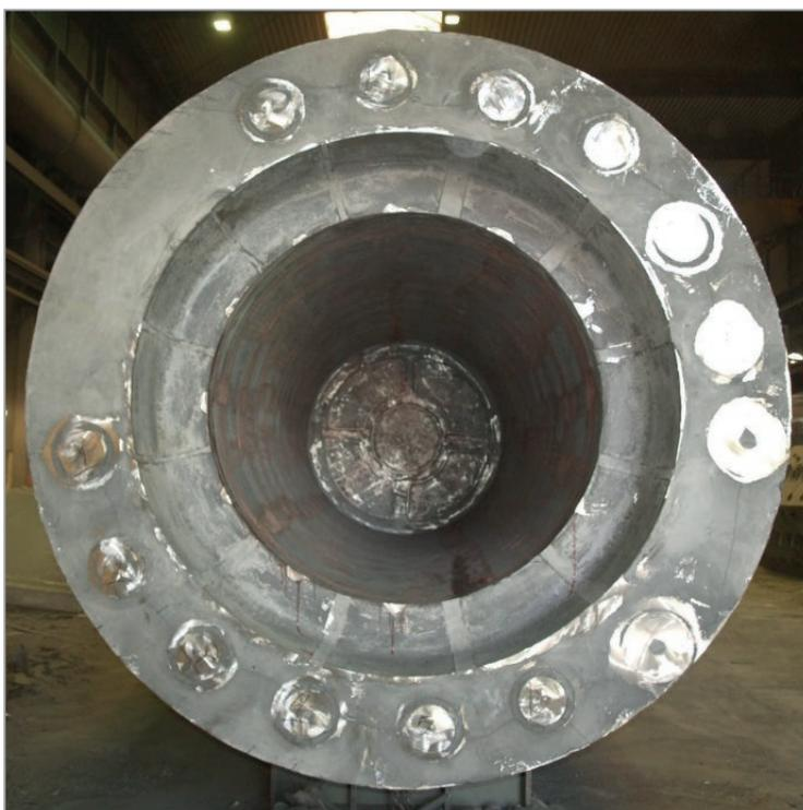
Рис. 6. Выбитая отливка со следами применяемых холодильников
