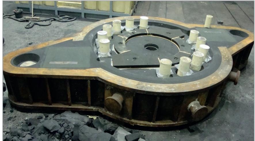
Рис. 2. Базовая конструкция формы с литниковой системой
