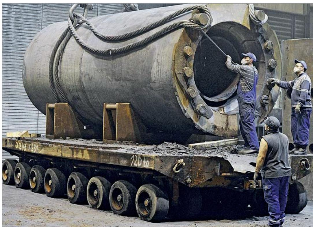
Рис. 5. Выбитая из формы отливка после дробеметной очистки
