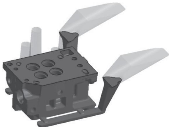
Рис. 9. Анализ образования усадочной пористости по сечению отливки «Головка цилиндра» после оптимизации прибыльной части
