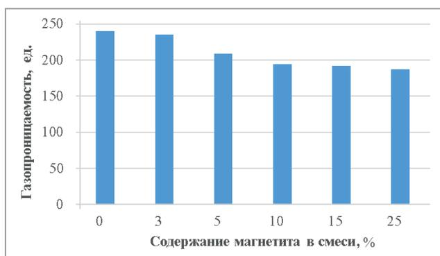
Рис. 3. Газопроницаемость образцов, изготовленных по Alpha-set-процессу
