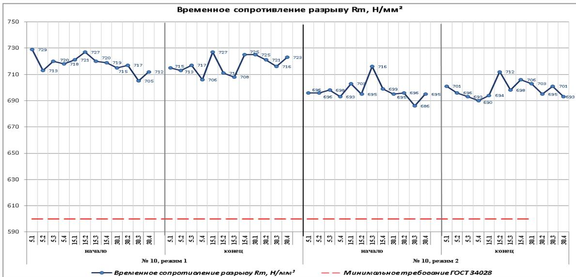
Рис. 7. Изменение временного сопротивления разрыву на арматуре № 10 класса прочности А500С
