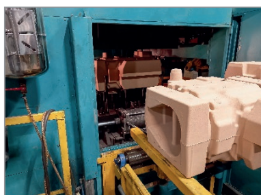
Рис. 1. Стержни, полученные на оборудовании ОАО «БЕЛНИИЛИТ», для производства отливок гидрораспределителей, железнодорожных рам и балок, головок и блоков двигателей внутреннего сгорания, насосного оборудования, картеров, мостов, тормозных дисков, сельхозтехники
