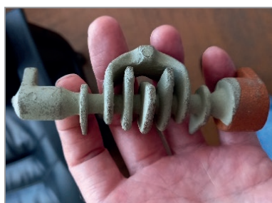
Рис. 1. Стержни, полученные на оборудовании ОАО «БЕЛНИИЛИТ», для производства отливок гидрораспределителей, железнодорожных рам и балок, головок и блоков двигателей внутреннего сгорания, насосного оборудования, картеров, мостов, тормозных дисков, сельхозтехники
