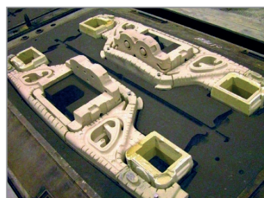
Рис. 1. Стержни, полученные на оборудовании ОАО «БЕЛНИИЛИТ», для производства отливок гидрораспределителей, железнодорожных рам и балок, головок и блоков двигателей внутреннего сгорания, насосного оборудования, картеров, мостов, тормозных дисков, сельхозтехники
