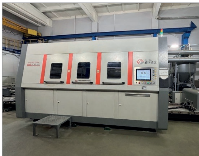
Рис. 2. Комплекс для печати полимерно-песчаных форм, установленный на ОАО «УКХ «ММЗ»: а – комплекс для печати; б – напечатанные на данном комплексе литейные формы и стержни:
