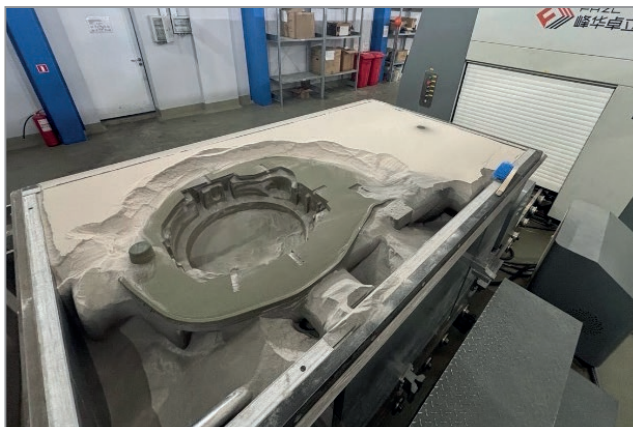
Рис. 3. Напечатанный литейный стержень, очищаемый от свободного (несвязанного) песка
