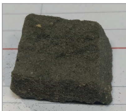
Рис. 4. Поверхность излома стержней: а – по традиционному фуран-процессу; б – методом АТ
