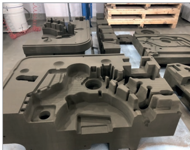
Рис. 2. Комплекс для печати полимерно-песчаных форм, установленный на ОАО «УКХ «ММЗ»: а – комплекс для печати; б – напечатанные на данном комплексе литейные формы и стержни:
