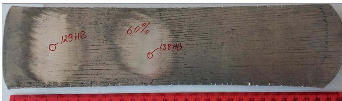
Рис. 4. Результаты прокатки по режиму № 6 (суммарная степень деформация 60% за пять проходов, табл. 3) литого образца при КГН 500g из АМг6; исходный размер до прокатки  $100 \times 70 \times 10$  мм
