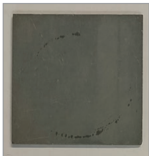
Образец с цинковым покрытием на базе порошкового Zn, полученным в установке диффузионного цинкования с вращающейся ретортой, в системе 50\% \text{Zn}_{\text{ст}} + 49\% \text{Al}_2\text{O}_3 + 1\% \text{NH}_4\text{Cl}
