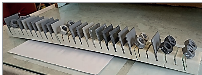
Рис. 6. Оцинкованные образцы и металлоизделия с резьбой перед их установкой в камеру соляного тумана
