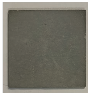
Образец с цинковым покрытием на базе цинковой пыли, полученным в установке диффузионного цинкования с вращающейся ретортой, в системе 50\% \text{Zn}_{\text{отх}} + 49,9\% \text{Al}_2\text{O}_3 + 0,1\% \text{изгарь} – отход горячего цинкования
