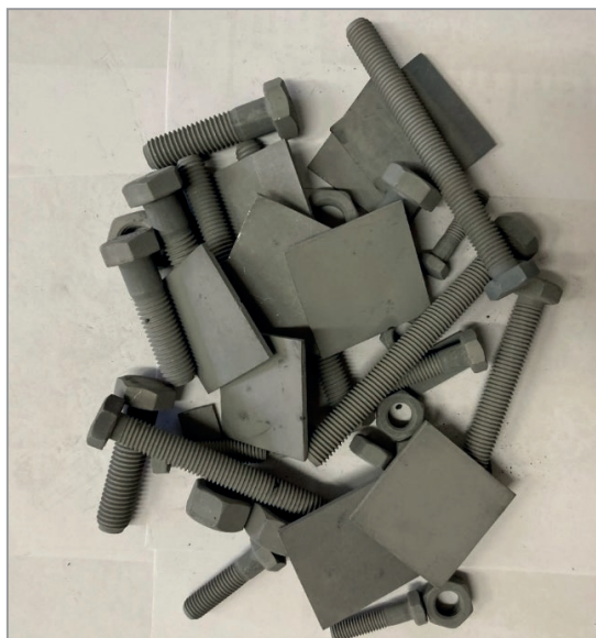
Рис. 2. Металлоизделия и пластины после нанесения цинкового покрытия
