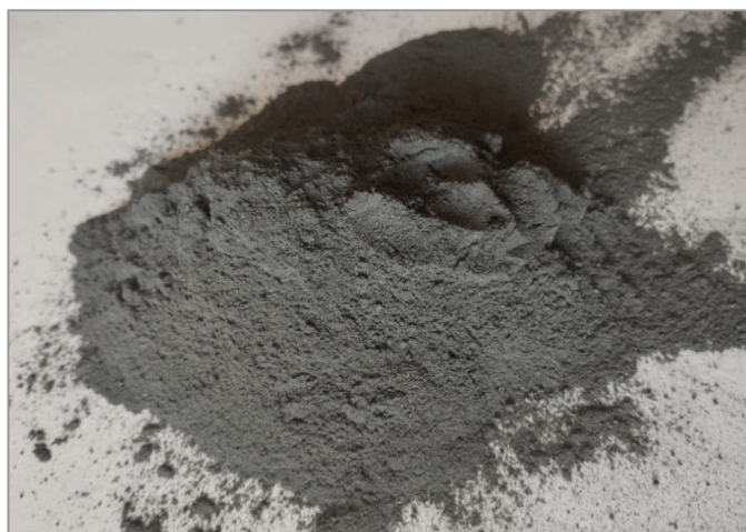
Рис. 1. Образец материала из отвалов флотационного обогащения медеплавильных шлаков
