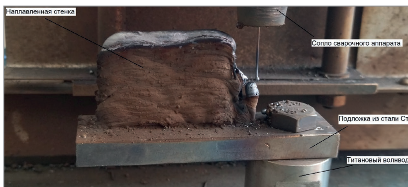
Рис. 2. Вид крепления к волноводу подложки, на которой наплавлена стенка по технологии послойной наплавки
