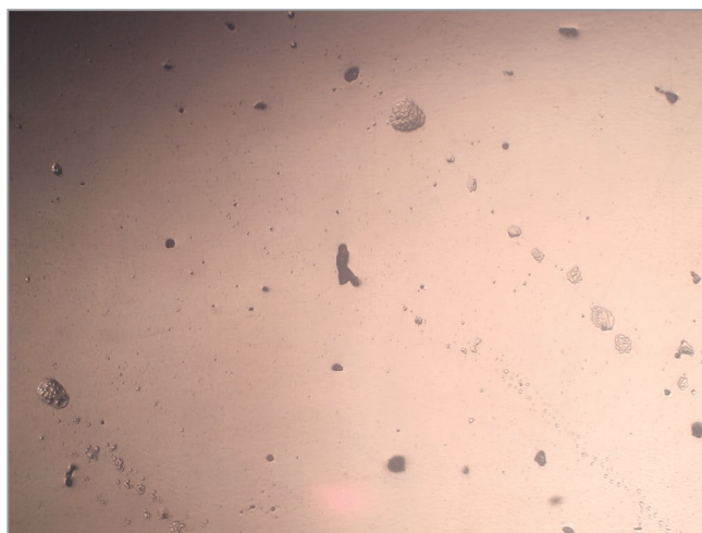
Рис. 9. Микроструктура поперечного сечения нетравленного образца, полученного послойным синтезом из механически легированного порошка (скорость перемещения луча – 1200 мм/с; толщина слоя – 30 мкм; мощность, потребляемая лазером, – 320 Вт)
