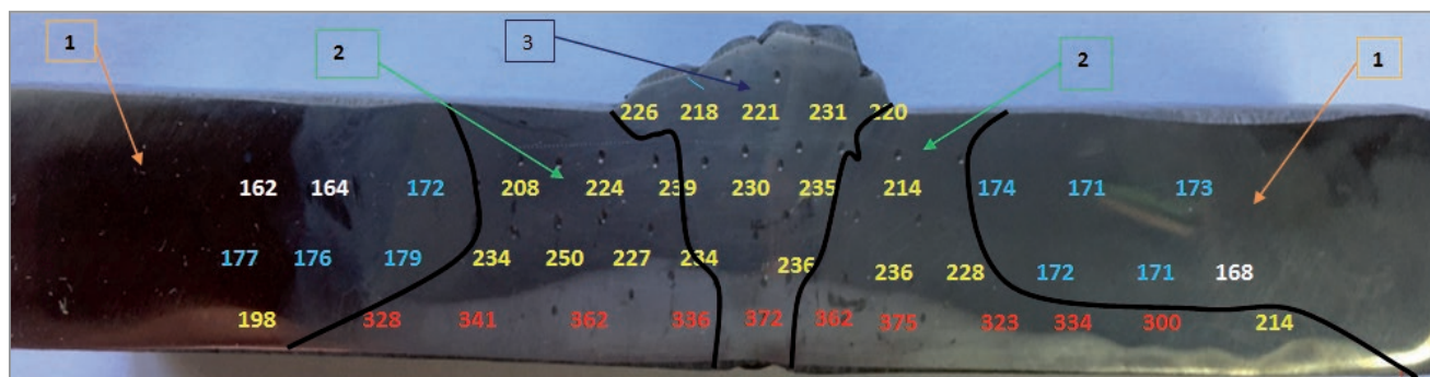
Рис. 3. Значения твердости по Бринеллю, идентифицированные по сечению сварного образца:
