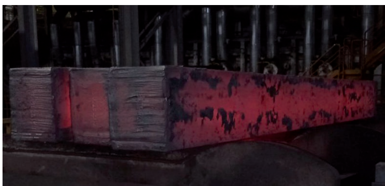
Рис. 1. Непрерывнолитые заготовки после нагревательной печи
